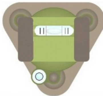
Fig. 2.11. Calarea definitivă a teodolitolui
