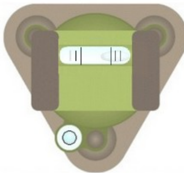
Fig. 2.9. Calarea aproximativă a teodolitului
